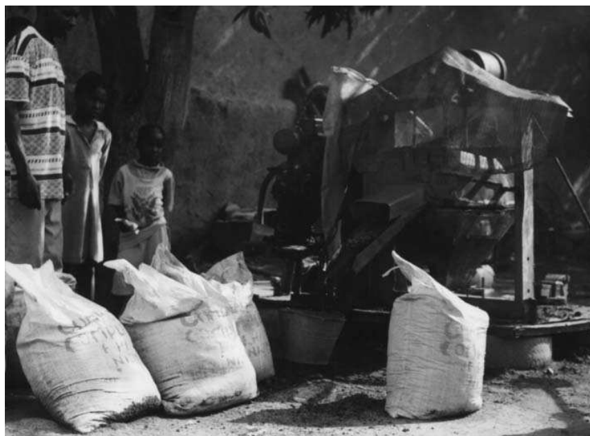
Fig. 4 Machine die compost met menselijke mest verhit en tot korrels maakt
